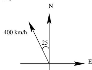
La composante de la vitesse vers l'ouest est  $|v_w| = (400 \text{ km/h}) \sin(25^\circ) \approx 169 \text{ km/h}$ , donc en deux heures, l'avion s'est déplacé de 338 km vers l'ouest.
