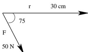
Le moment de force est  $\vec{\tau} = \vec{r} \times \vec{F} = |\vec{r}||\vec{F}| \sin \theta \hat{n} = (0.3 \text{ m})(50 \text{ N}) \sin(75^\circ) \hat{n} \approx 14.5 \text{ Nm}$  vers le bas (le boulon est serré).
