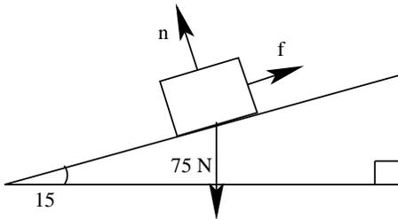
Puisque l'objet n'est pas en mouvement, il y a une force de friction  $\vec{f}$  dont l'effet est parallèle au plan et une force normale  $\vec{n}$  dont l'effet est perpendiculaire au plan, donc la somme contre-balance le poids (*ie* la force due à la gravitation).
