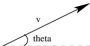
Il peut être décomposé en sa composante horizontale  $\vec{v}_h$  et composante verticale  $\vec{v}_v$ , où  $\vec{v} = \vec{v}_h + \vec{v}_v$  (et  $\vec{v}_h \perp \vec{v}_v$ ).
